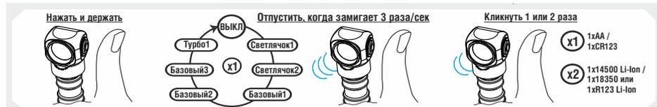
Для входа в меню следует нажать и удерживать кнопку выключенного фонаря. Фонарь включится, произведет перебор режимов, затем через 2 сек работы Turbo1 войдет в меню и будет мигать с частотой примерно 3 раза в секунду. Отпустите кнопку.
